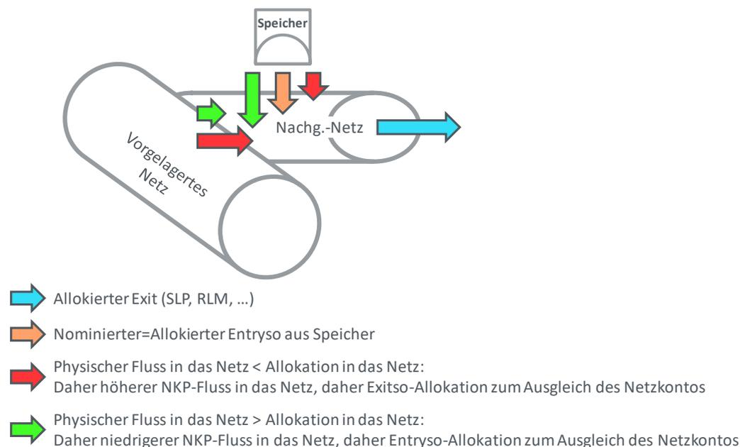
**Abbildung 29: NKBO-Allokation bei OBA Ausspeicherung**
