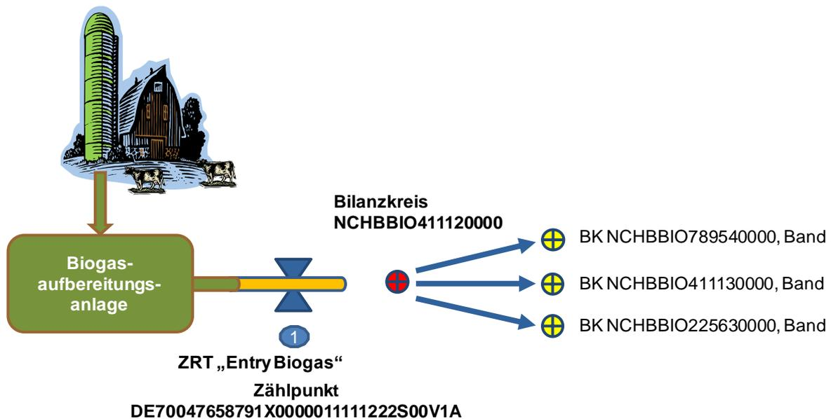
**Abbildung 13: Beispiel für eine Aufteilung von Biogaseinspeisungen auf verschiedene Bilanzkreise**
