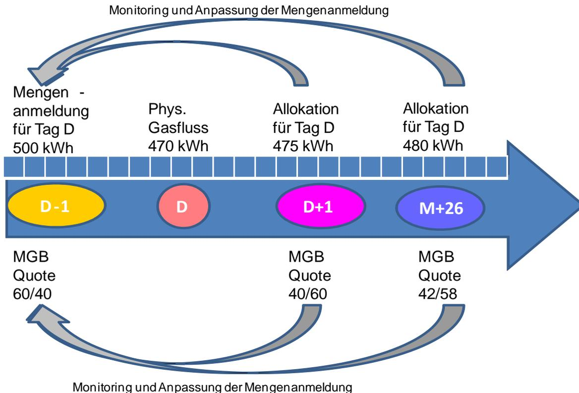
**Abbildung 20: Monitoring der Mengenanmeldung durch den NB**
