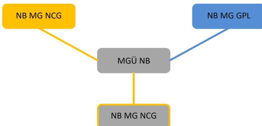
**Abbildung 10: Beispiel für einen NB der nicht unter die Regelungen der Marktgebietsüberlappung fällt – fehlende strömungsmechanische Möglichkeit**
