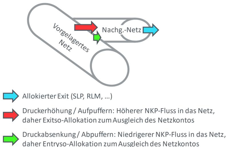
**Abbildung 28: NKBO-Allokation bei Netzpuffer**
